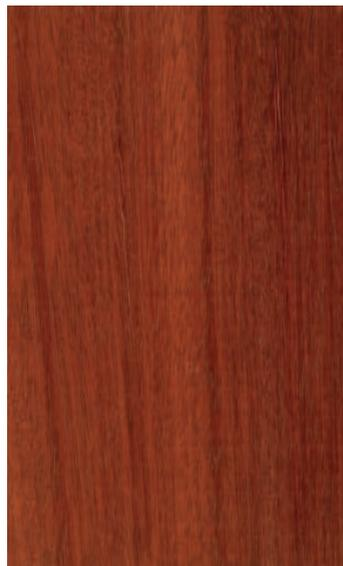
**Obs.:** cuidado na secagem artificial; possui tendência a rachaduras, encanoamento e torcedura<sup>(39)</sup>.
